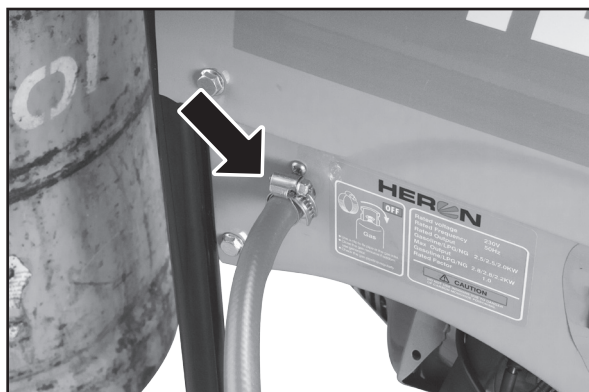
A gáztömlő csatlakoztatási módja 14. ábra
